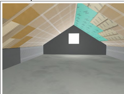
Fig. 16: Posa su travetti o tra due strati di pannelli.
