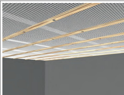
Fig. 12: Fissaggio dei teli con l'ausilio della listellatura
