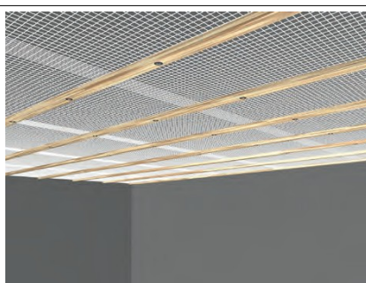
Fig. 5: Fissaggio dei teli con l'ausilio della listellatura
